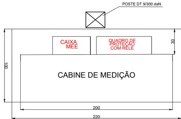
MURETA DE MEDIÇÃO COM QUADRO DE PROTEÇÃO E RELÉ
